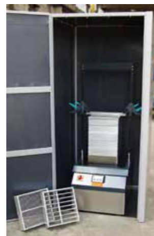
ASM 400 с шумозащитным корпусом и ситовыми ящиками
